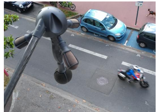
Vue du capteur « méduse » en situation (crédits : Bruitparif)
